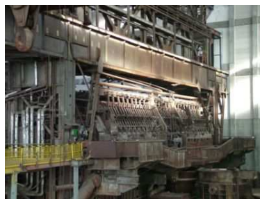
Obr.: Siemens - Martinova pec http://im.encyklopedie.seznam.cz/
