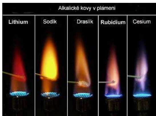
Obr.: barvení plamene alkalickými kovy chemické prvky. enweb.cz/alkalicke-kovy.htm
